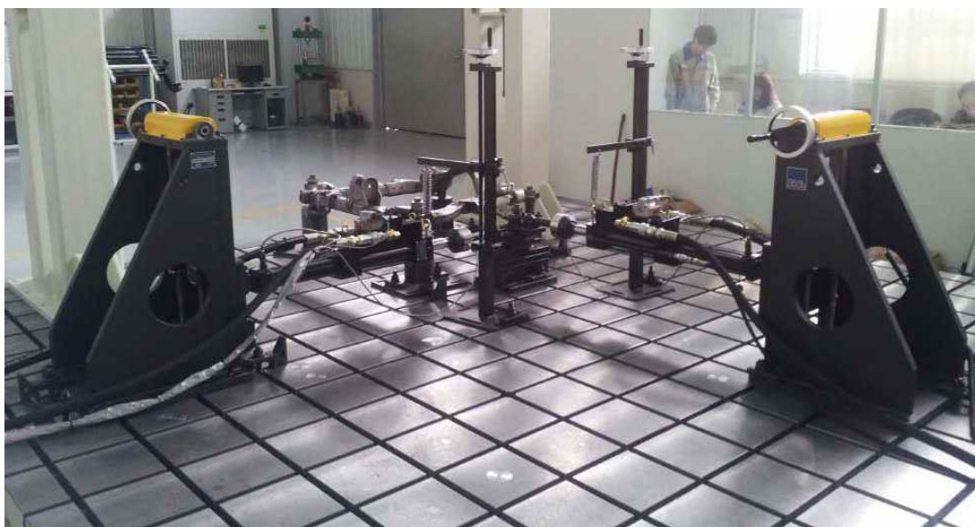
①유압공급장치, ②유압분배기, ③④서보액츄에이터, ⑤T-slot 정반, ⑥디지털 서보제어기, ⑦칠러, ⑧수평반력대, ⑨실린더 길이
